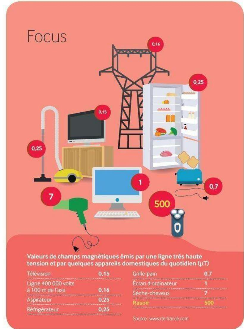
Figure 84 : Valeur de champs magnétique émis par une ligne très haute tension et par quelques appareils domestiques du quotidien, Source : <http://www.clefdeschamps.info/>, RTE
