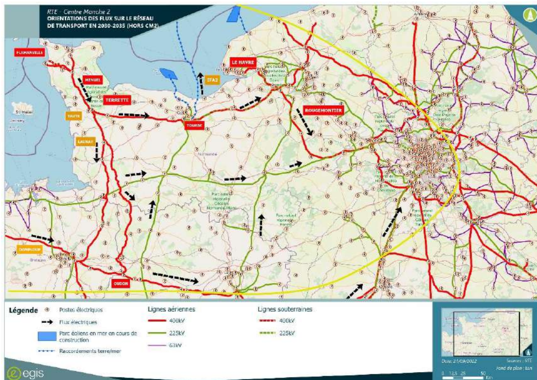
Figure 4 : Orientation des flux sur le réseau de transport en 2030-2035 avec le premier parc et sans le deuxième parc en zone Centre Manche (RTE, Esri, EGIS, 2022)
