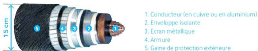
Figure 7 : Schéma de principe d'un câble sous-marin (RTE, 2021)
