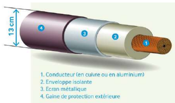
Figure 16 : Schéma de principe d'un câble conducteur à haute-tension (RTE, 2021)
