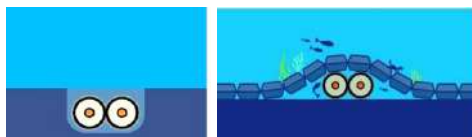
Coupe schématique d'un ensouillage (à gauche) et d'une protection externe (à droite) d'un bipôle
