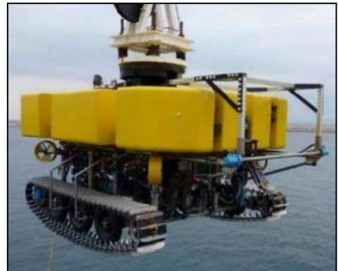
Engin de water-jetting
