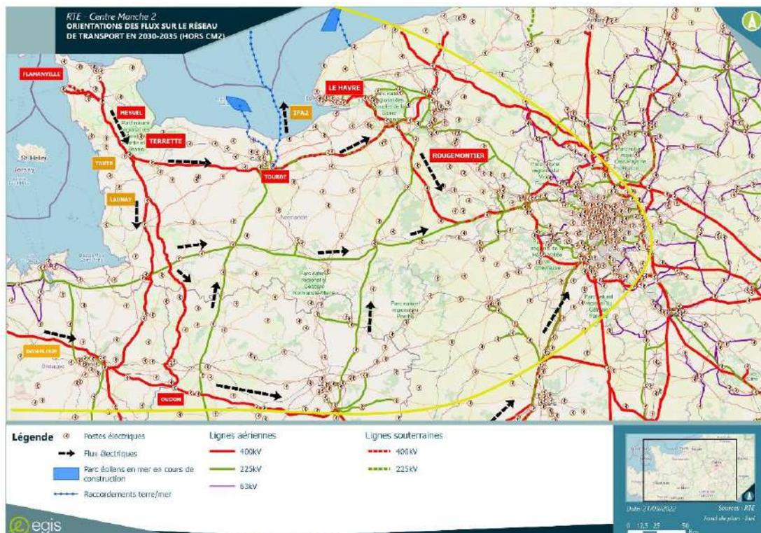
Figure 4 : Orientation des flux sur le réseau de transport en 2030-2035 avec le premier parc et sans le deuxième parc en zone Centre Manche (source : RTE, 2022)
