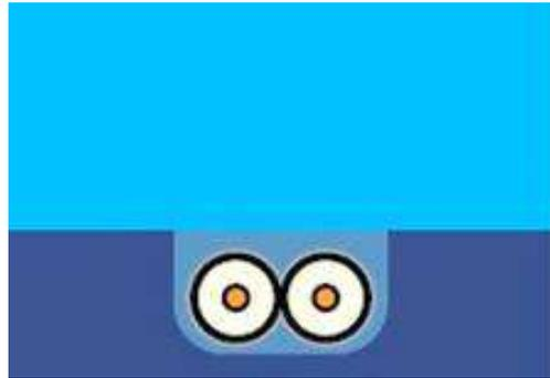
Figure 9 : Coupe schématique d'un ensouillage\* d'une paire de câbles (source : RTE, 2021)
