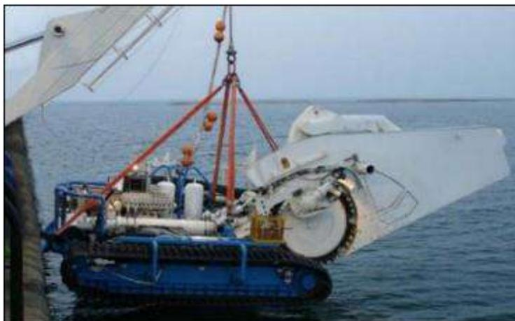
Figure 16 : Trancheuse mécanique à roue (source : RTE, 2021)
