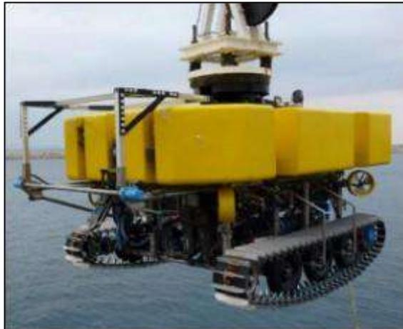
Figure 15 : Engin de water-jetting (source : RTE, 2021)
