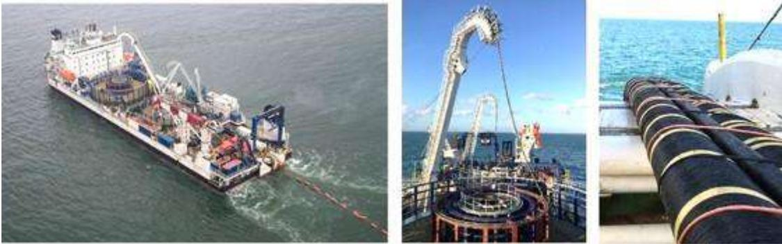
Figure 13 : Pose d'un câble sous-marin par un navire câblé (source : RTE, 2021)
