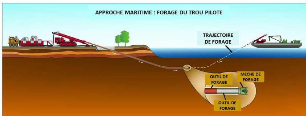
Figure 18 : Schéma d'un forage dirigé à l'atterrage en milieu maritime (source : RTE, 2022)
