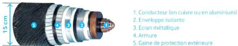
Figure 7 : Schéma de principe d'un câble sous-marin (source : RTE, 2021)
