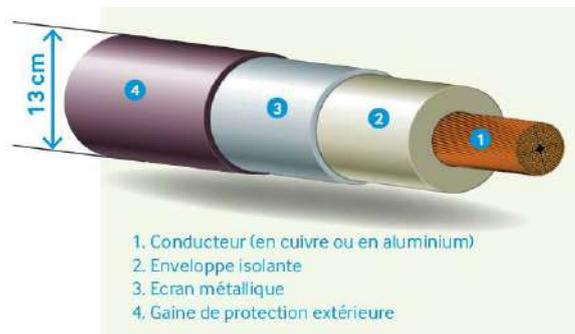
Figure 19 : Schéma de principe d'un câble conducteur à haute-tension (source : RTE, 2021)
