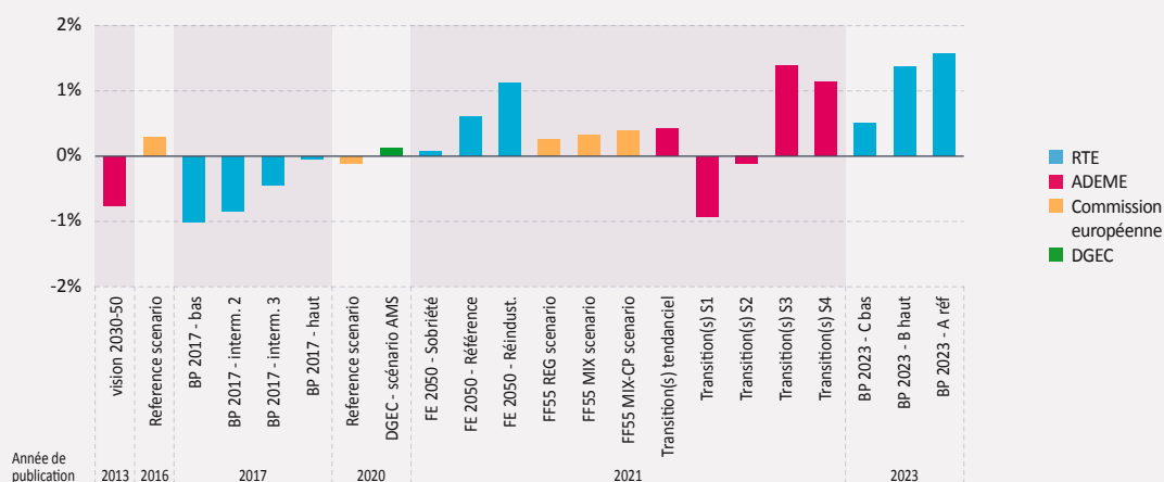
Figure 2.12 Taux de croissance annuel moyen de la consommation d'électricité en France à l'horizon 2030 dans différentes études
