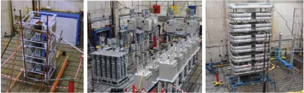
Figure 13 — Test des 3 disjoncteurs HVDC de Scibreak, de Mitsubishi et d'ABB dans les labos de KEMA (Photos extraites du rapport PROMOTiON D10.9 « Reporting on HVDC circuit breaker testing »)
