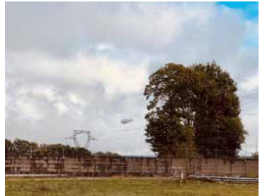
Figure 3- Début d'inspection automatique Pas de risque d'amorçage: le drone se situe à plusieurs dizaines de mètres des câbles
