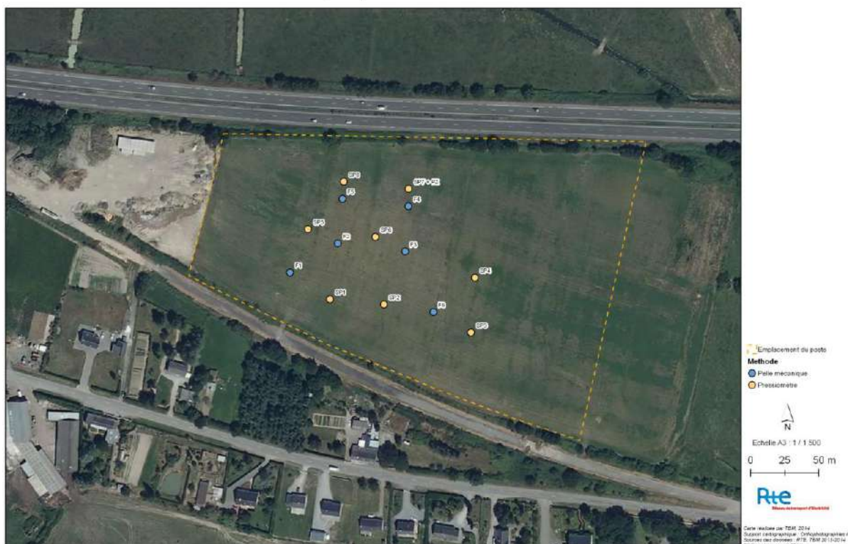
Figure 147 : localisation des sondages géotechniques
