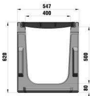
Modèle TI 400 type 500 de chez HAURATON, section de 1838cm 2
