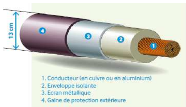
Coupe schématique d'un câble souterrain (Source RTE)
