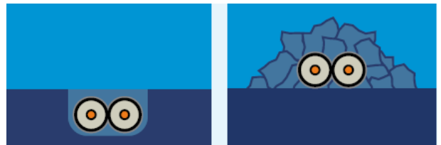
Coupe schématique d'un ensouillage (à gauche) et d'une protection externe (à droite) (Source RTE)
