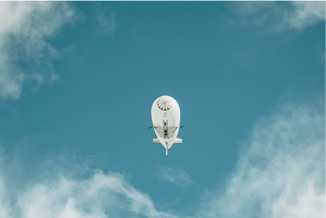
Figure : Prototype de Diridrone lors d'essais en conditions réelles en 2020 Longueur: 14,5m Largeur: 4,5m Masse: 150 kg Charge utile: 10 kg
