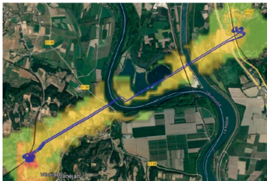
Figure : Simulation des risques aéronautiques sur une inspection de ligne
