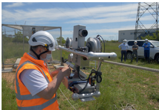
Figure : Test d'un robot d'inspection du réseau
