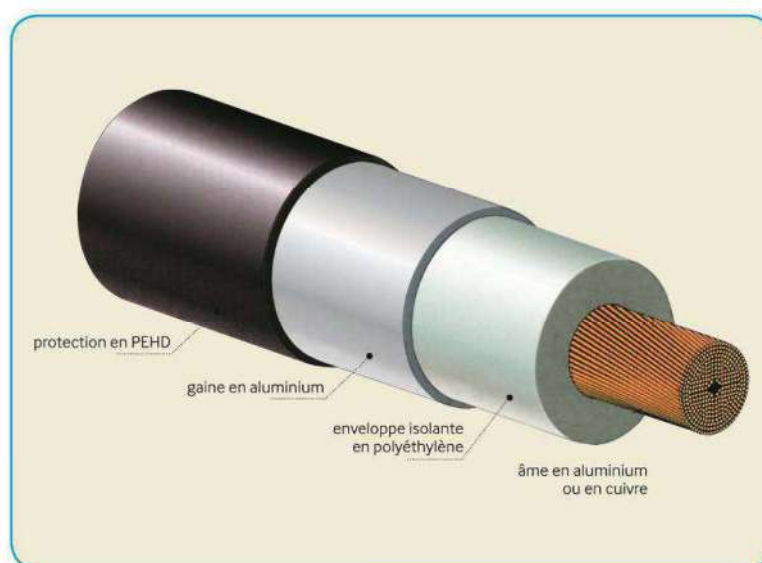
Figure 8 : Coupe d'un câble souterrain (RTE)
