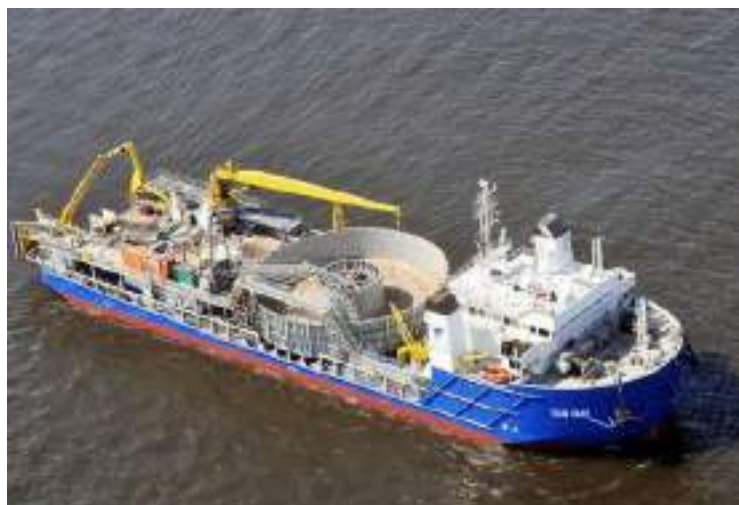
Figure 19 : illustration d'un navire posant des câbles - Source : Global Marine System
