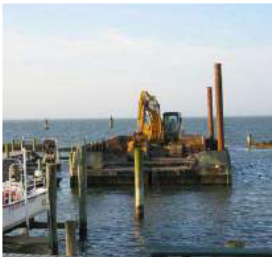
Figure 15 : exemple de pelle mécanique sur barge autoélevatrice
