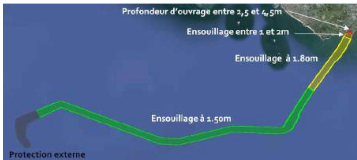
Figure 10 : objectifs de protection des câbles sous-marins (*)
