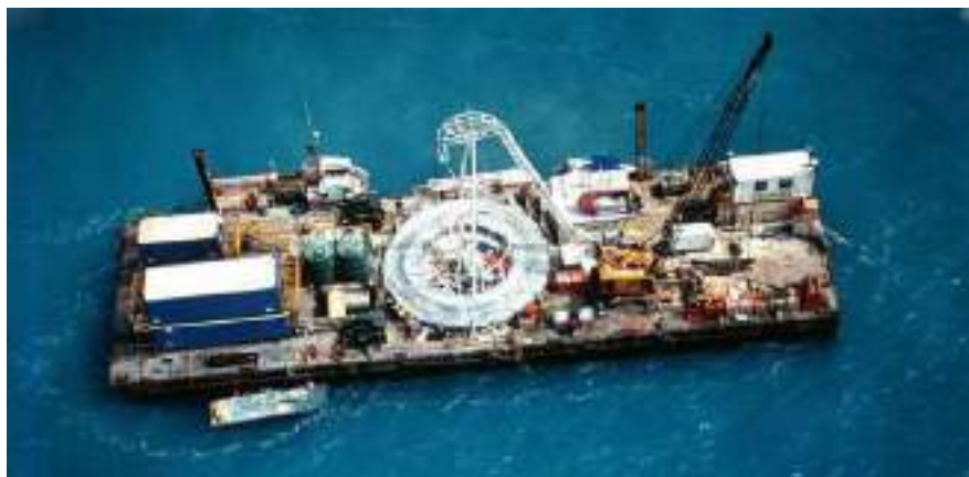
Figure 18 : exemple d'une barge de pose
