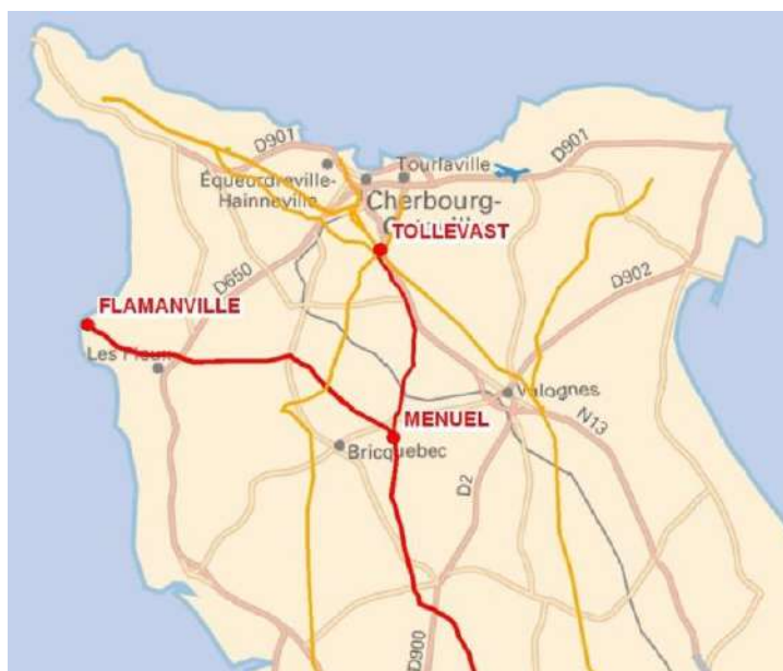
Le réseau 400 000 volts (en rouge) du Cotentin et le réseau 90 000 volts (en orange)
